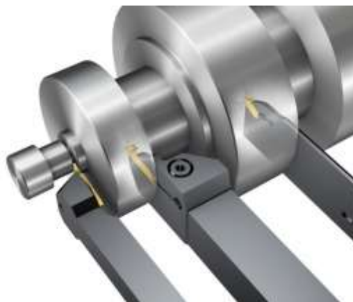
Рисунок 1- Обработка наружных канавок канавочными резцами с СПМ
