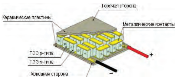
Рисунок 2 - Термоэлектрический генераторный модуль в разрезе
